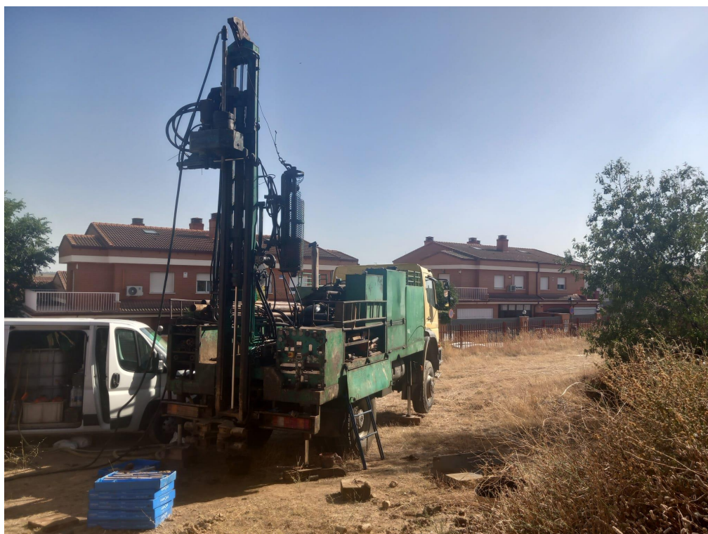
Figura Nº 7.- Imagen de la ejecución del sondeo mecánico y rotativo con extracción continua de testigo referido como S-02.
