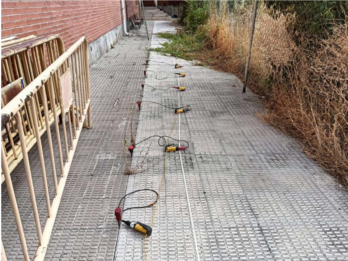
Figura 7. Fotografía de la implantación sísmica utilizada en el presente estudio.
